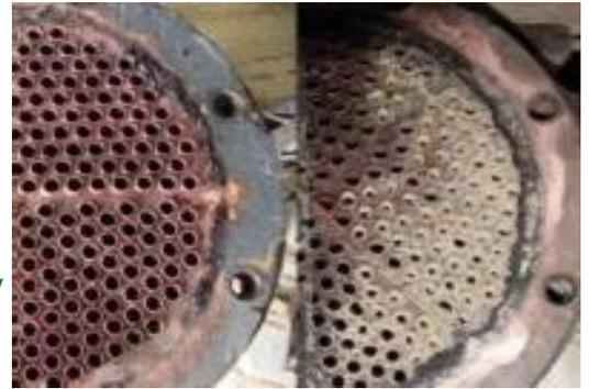
細管の直径が16mmとして、スケールが厚さ0.1mm付着するとエネルギー効率が15%低下
